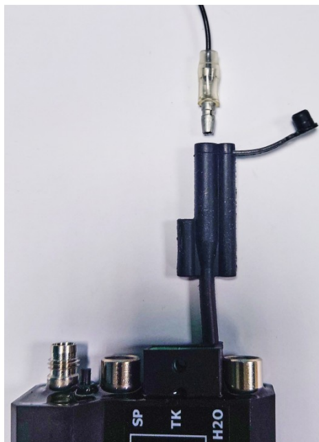
Direkter elektrischer Anschluss des RPM-Signals
