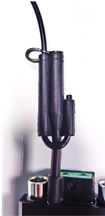
Silikonverbinder des WID-D-Moduls
