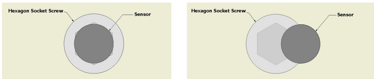
Sensorausrichtung: links falsch, rechts richtig
