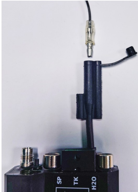
Direkter elektrischer Anschluss des RPM-Signals
