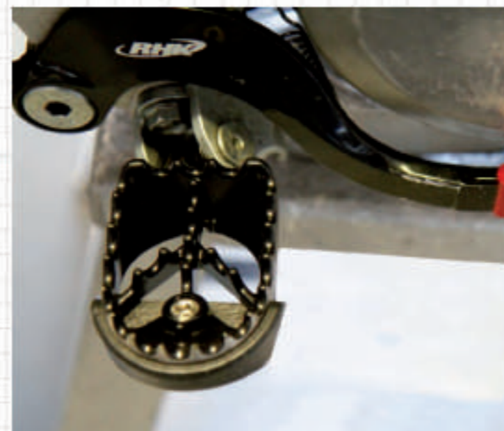
Supermoto-Fußraste mit austauschbarem Schleif-Pad
