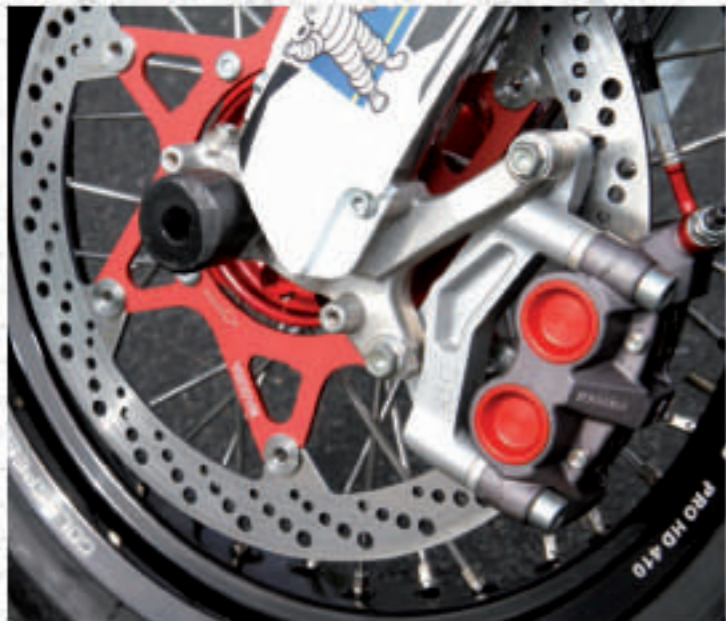
Der vordere Stopper ist via Adapter radial montiert
