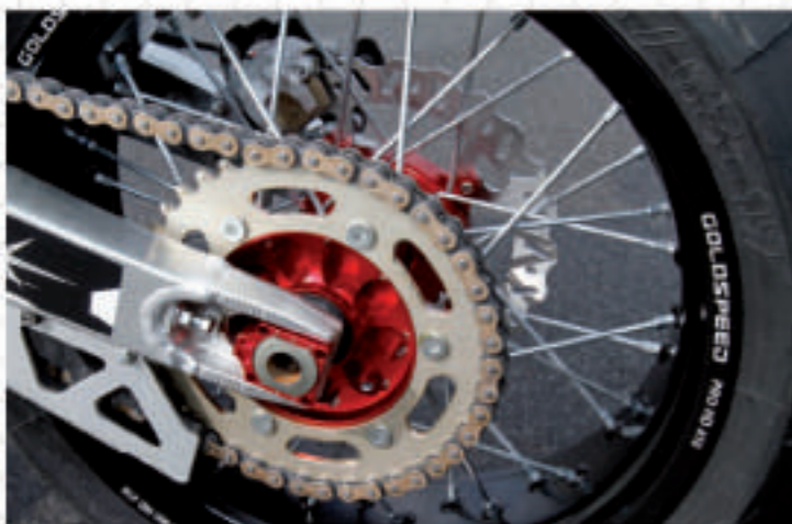
Die Übersetzung wird über ein anderes Ritzel angepasst
