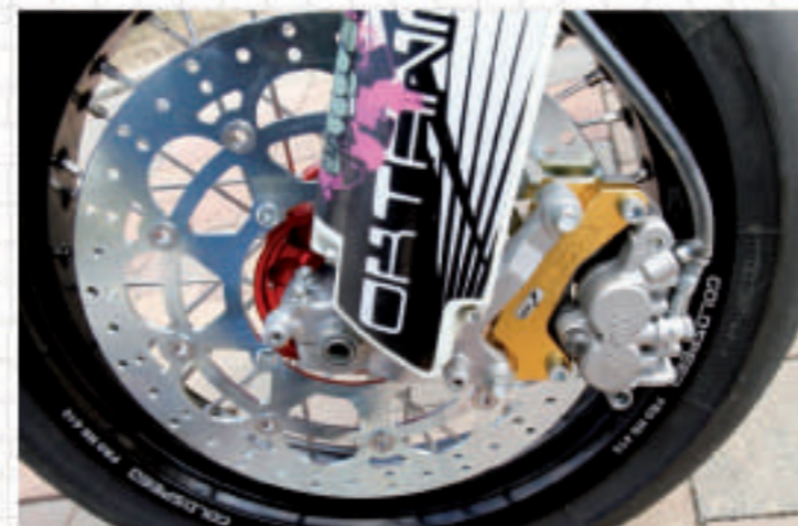
Mittels Adapter ist der Bremsattel am Gabelfuß montiert
