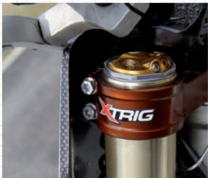
An den CNC-gefrästen Brücken kann der Versatz eingestellt werden
