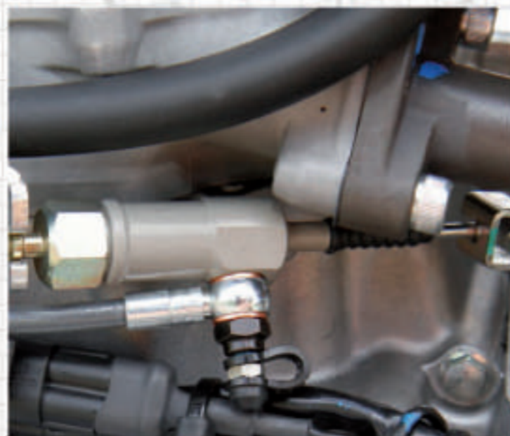
Ein kleiner Zylinder verrät: Hier wird hydraulisch gekuppelt
