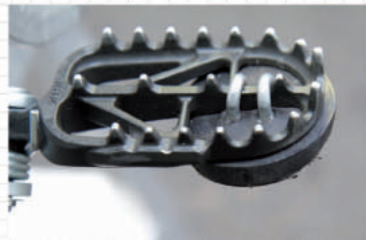
Sturz pads auch an den Fußrasten (schneller Eigenbau)
