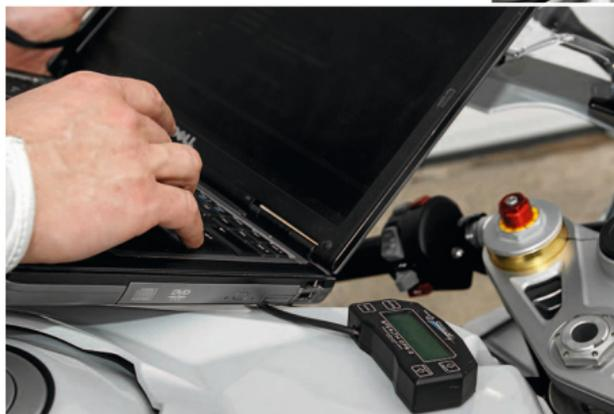
**Die gesammelten Daten des Stealth GPS-2 lassen sich mühelos via Bluetooth auf den Rechner ziehen.**
